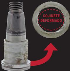
Una carga descentrada constante puede deformar el cojinete
