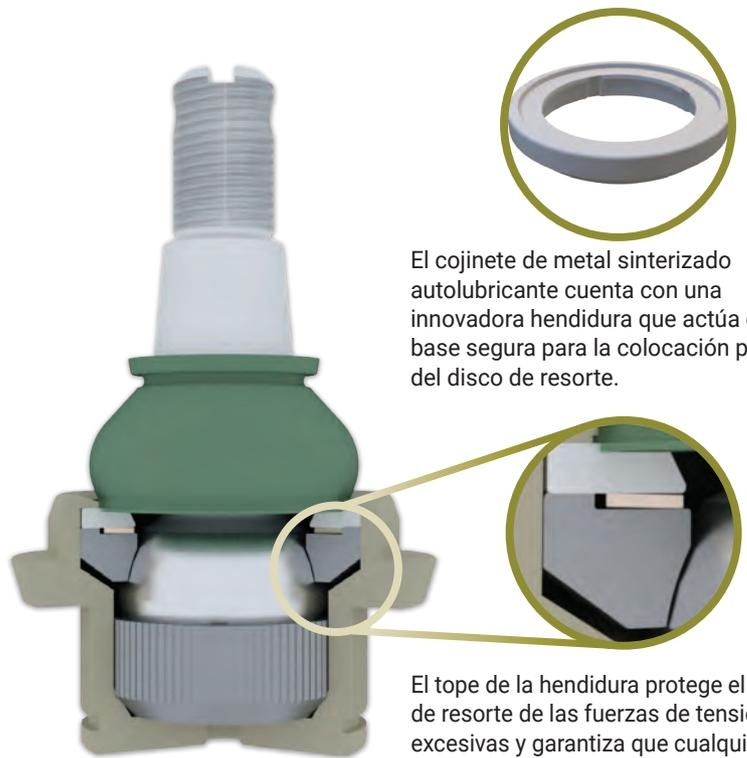
El cojinete de metal sinterizado autolubrificante cuenta con una innovadora hendidura que actúa como base segura para la colocación precisa del disco de resorte.
