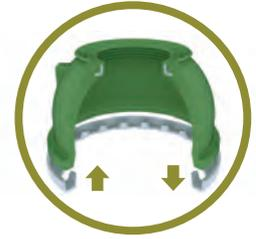
Un método avanzado de adhesión entre el metal y la funda crea una base duradera, sólida y de larga vida útil. Esto elimina la necesidad de usar un anillo en espiral.
